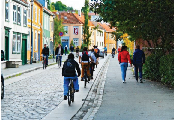
Figur 3.14: Spesiell steinsetting langs sykkelrute med heller eller saget brostein
