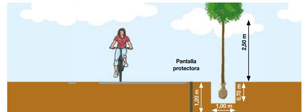
Figura 53.- Esquema de plantación de un árbol
