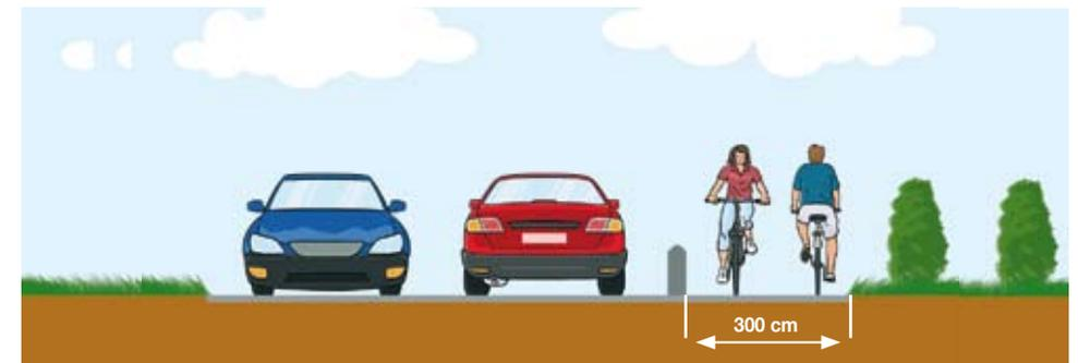
Figura 4.- Carril bici protegido bidireccional en zona interurbana
