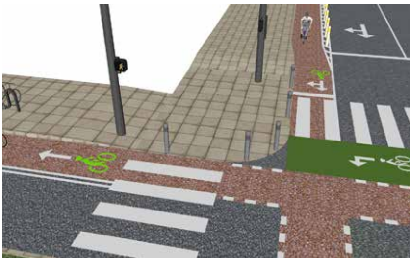
可改善司机和骑车者在接近路口时视线的交叉路口，及“两步左转”自行车专用等待区。
