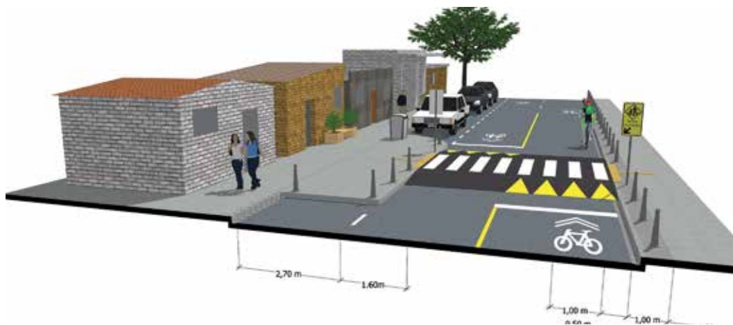
某条具有路面标线和交通稳静化措施的共享自行车街道（自行车大道）。
