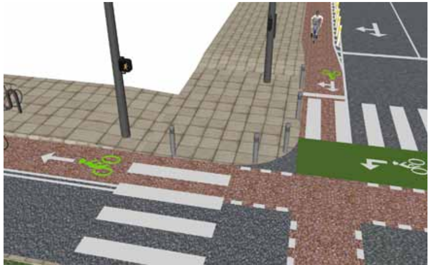
Nút giao cắt cần tăng cường tầm nhìn giữa người lái xe và người đi xe đạp khi họ đến nút giao cắt, và có ô rẽ trái theo hai bước.
