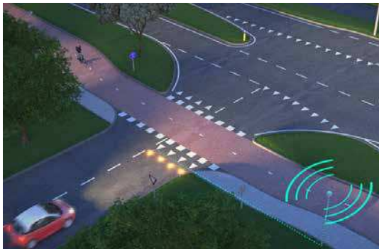
Voorbeeld van innovatie, de BikeScout. Fietzers worden gedetecteerd met radartechniek en automobilisten worden via LED-verlichting geattendeerd op overstekende fietsers
