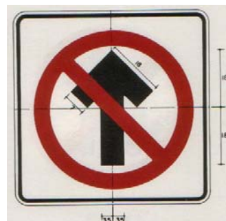
Fig. 4.29 Señal de prohibido seguir de frente
