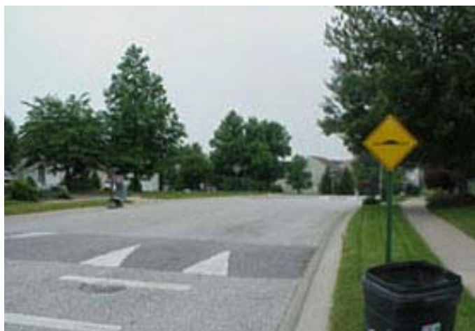
Imag. 3.07 Topes de velocidad con una elevación gradual favorable para los ciclistas
