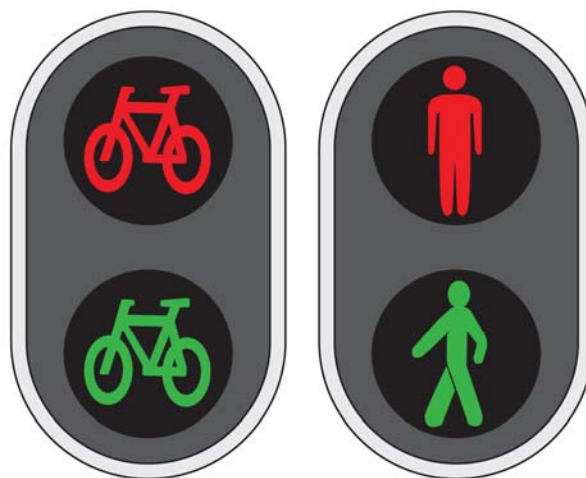
Fig. 5.09 Semaforización para ciclistas y peatones Fuente: ALTA Planning, 2010
