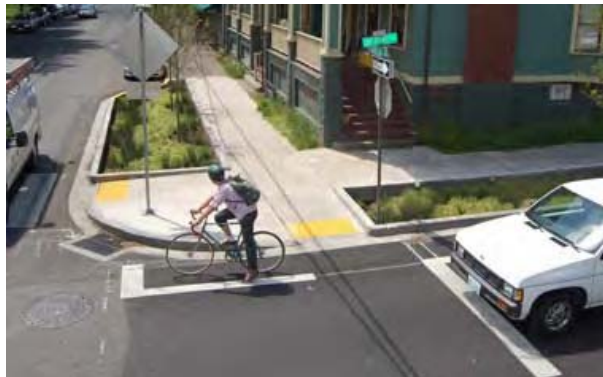
Imag. 5.24 Línea de contención avanzada
