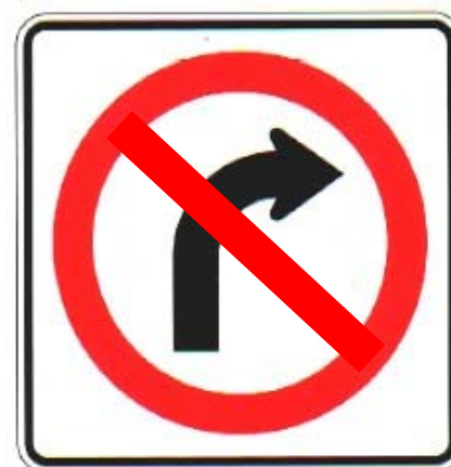
Fig. 4.21 Señal SR-23 Prohibida la vuelta derecha. Ver Manual de dispositivos para el control de tránsito en calles y carreteras.
