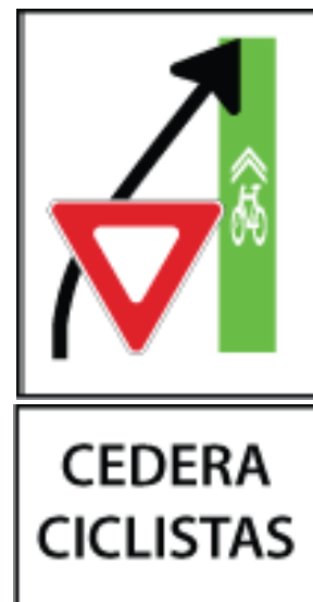
Fig. 5.08 Señal vertical de ceda el paso al ciclista Fuente: ALTA Planning, 2010
