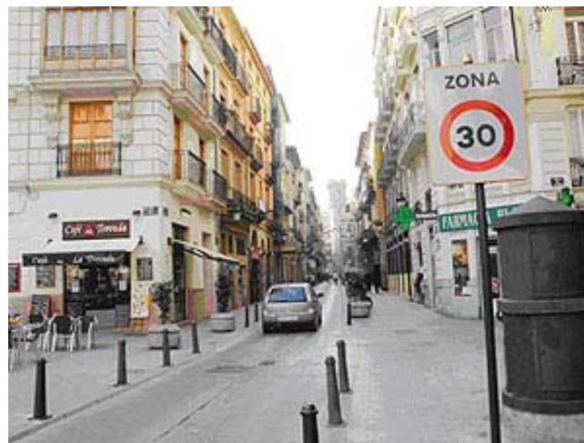
Imag. 3.11 Zona 30 en centro histórico con la utilización de bolardos para separar el tráfico vehicular de peatones
