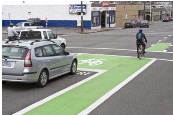
Imag. 5.02 Color verde utilizado para la señalización horizontal ciclista
