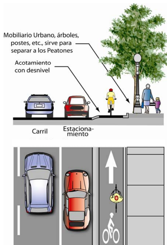
Fig. 5.06 Ciclovía segregada a nivel intermedio entre el arroyo y la banqueta Fuente: Alta Planning, 2010
