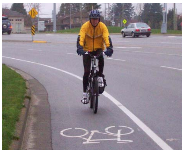
Imag. 5.14 Ciclobanda en vialidad con poco tráfico
