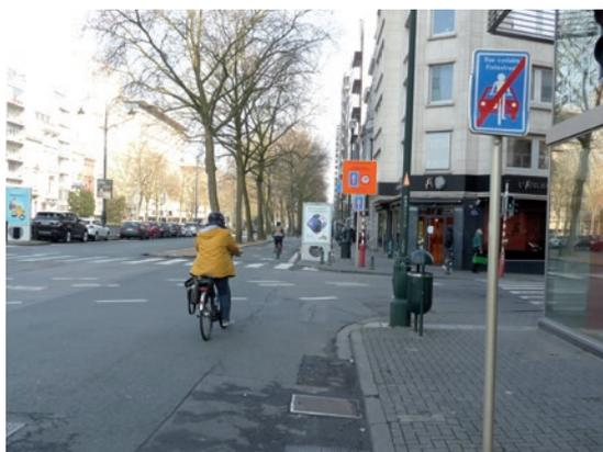
Rue cyclable interrompue à hauteur du carrefour. Le panneau F113 est placé à la fin de la rue cyclable et le panneau F111 est placé après le carrefour au début d'une nouvelle rue cyclable.
