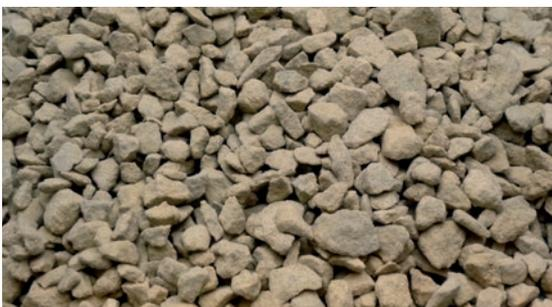
Granulats de grès jaune utilisés pour la fabrication d'enrobés bitumineux colorés.
