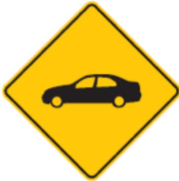
Esta señal se emplea para advertir al ciclista la proximidad a un tramo de la ciclorruta sobre el cual pueden cruzar vehículos automotores y por lo tanto se deben tomar las precauciones necesarias para evitar colisiones o choques.]
