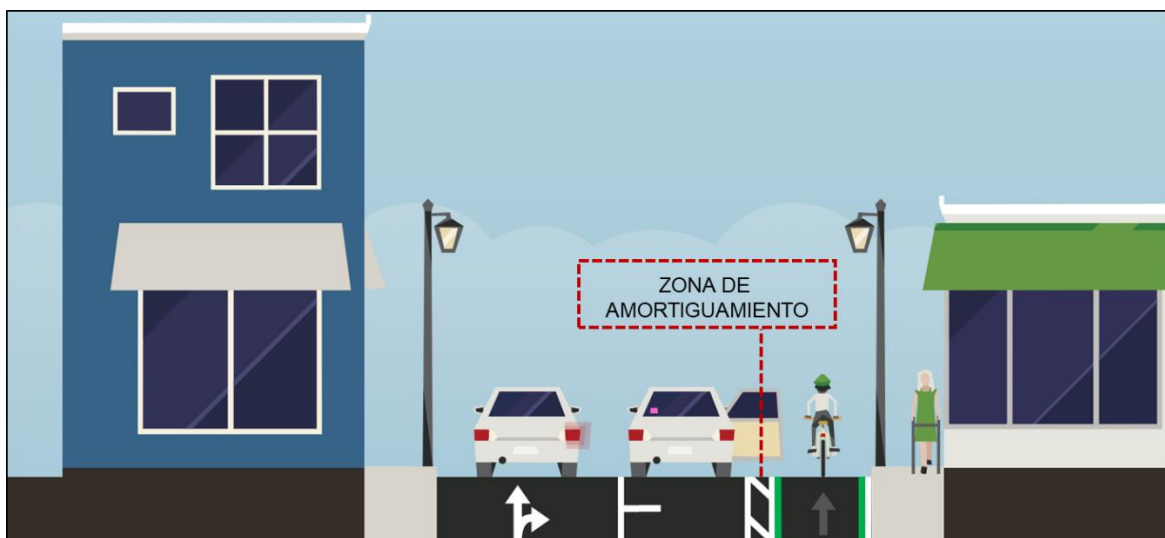
Figura 6. Facilidad segregada Tipo 1 con estacionamiento.
