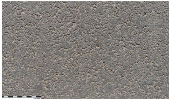
*Béton bitumineux BB-1B*
