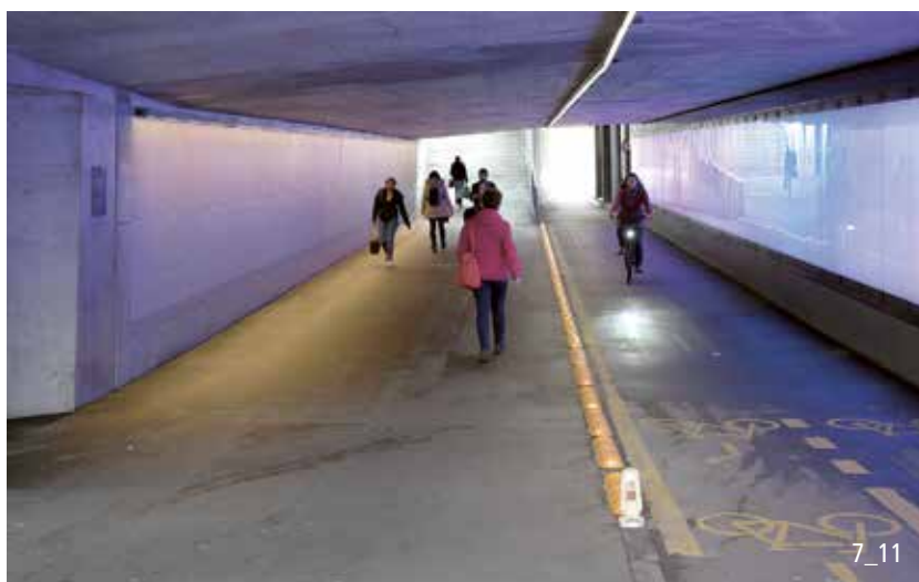
Surfaces piétonne et cyclable séparées dans le cas d'une fréquentation moyenne à forte.
