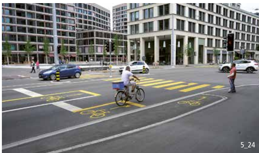
Tourner-à-gauche indirect avec zone d'attente dédiée.
