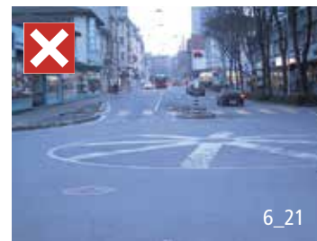
Non cyclo-conforme en raison de l'îlot central franchissable; ne convient pas non plus en tant qu'aménagement provisoire.
