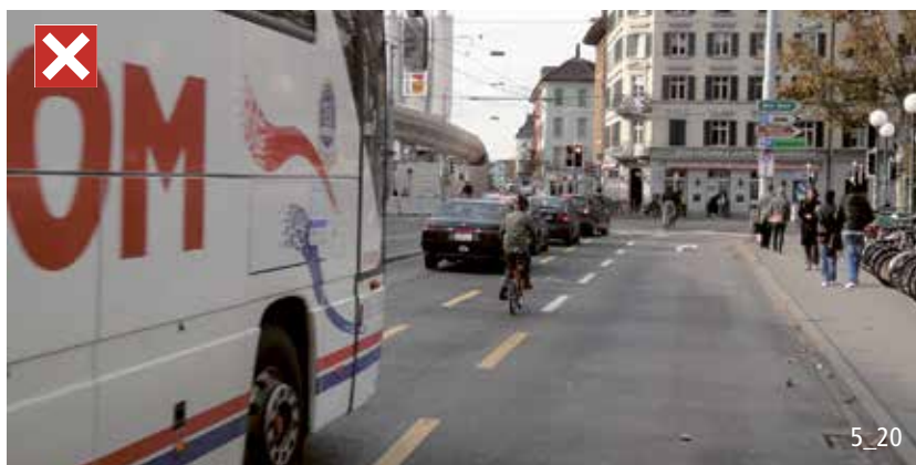
Les bandes cyclables en milieu de chaussée trop étroites ou trop longues ne sont pas cyclo-conformes.
