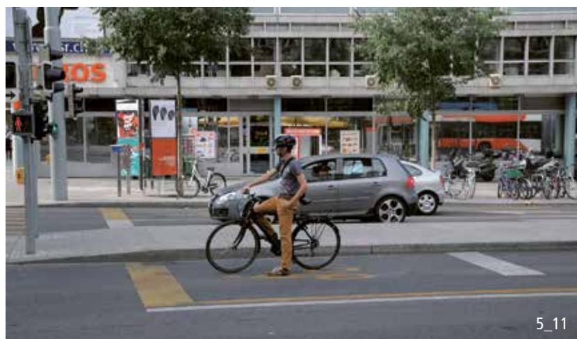
Sas pour cyclistes, profondeur min. 4.0 m.
