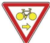
Les panonceaux de type M12 ont un côté nominal compris entre 150 et 300 mm. Lorsque la lisibilité est jugée insuffisante et en l'absence de panneau AB, ce côté peut être porté à 500 mm.
