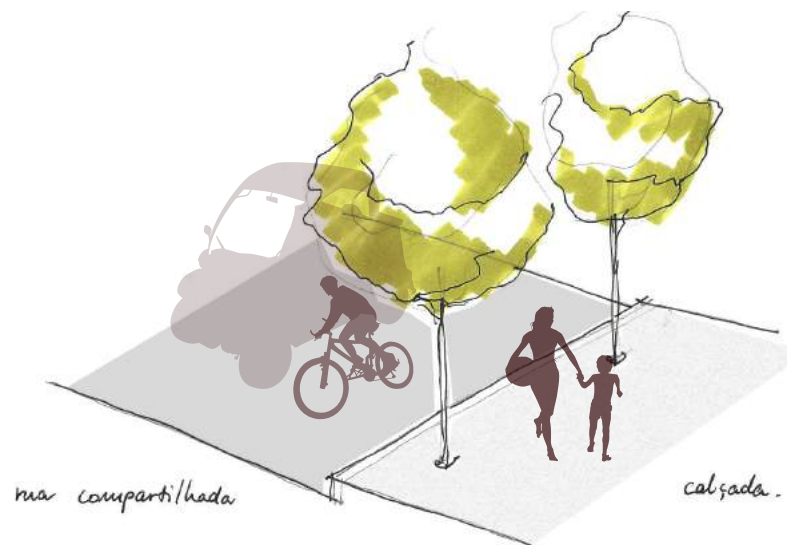
Imagem 13: Esquema de funcionamento de uma via de trânsito compartilhado sinalizado (ciclorrota) Fonte: TC Urbes, 2015
