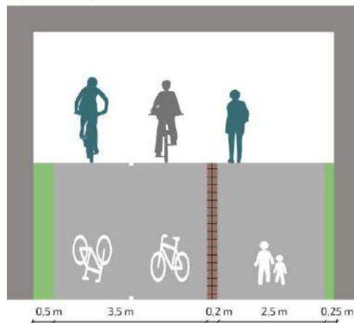
Kuva 164 Esimerkki alikulun leveyden mitoituksesta.
