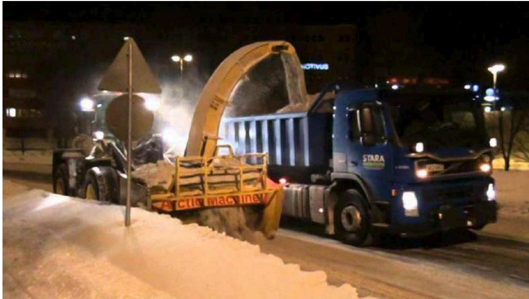
Kuva 36 Lumen linkoaminen kuljetusauton lavalle (valokuva Arctic machine).
