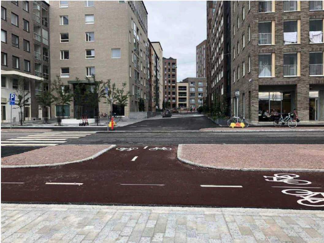
Kuva 198 Jalkakäytävällä ja pyörätiellä vältetään suurilta kaltevuuseroilta, kun pyörätien taso on lähellä ajoradan tasoa.
