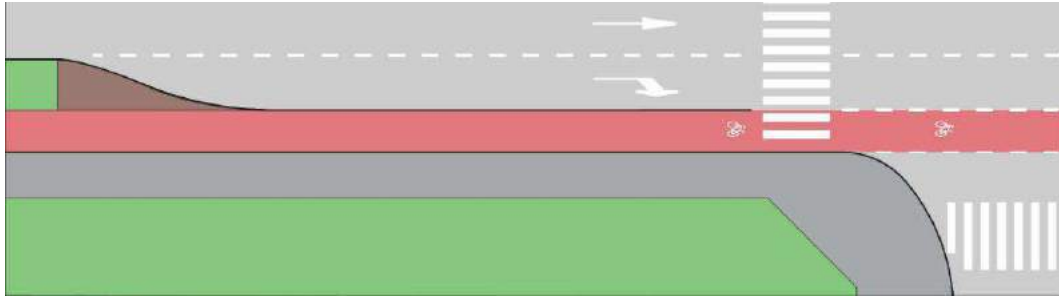
Kuva 95 Pääsuunnan oikealle kääntymiskaista autoliikenteelle on pyöräilijälle selkeä ratkaisu.
