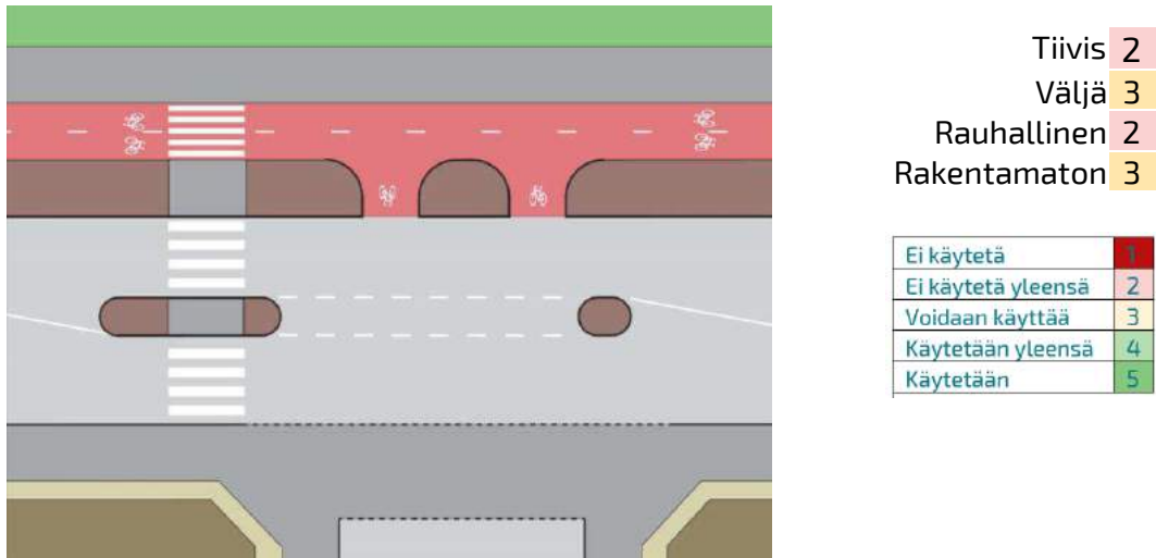
Kuva 140 Kaksisuuntaisen pyörätien sekä tontti- tai muun rauhallisen kadun rakenteellinen ylityskohta. Pyöräliikenteen ryhmitysalue jaetaan suunnittain.
