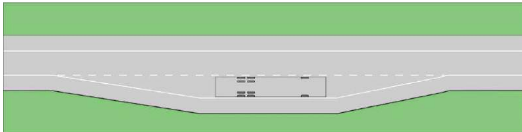
Kuva 81 Pyöräliikenne ohjataan pysäkin takaa kylätiellä.
