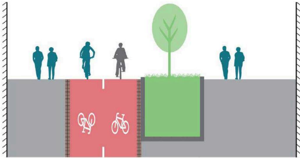
Kuva 66 Pyörätien havaittavuutta voidaan korostaa värillisellä pinnoitteella etenkin, jos muu kävelypainotteinen alue on asfaltilla toteutettu. Puurivi jäsentää tilaa hyvin, muttei estä poikittaista kulkemista.
