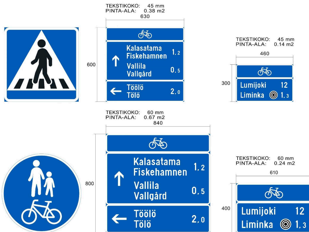
Kuva 14. Pyöräilyn suunnistustaulujen mittoja ja niiden suhde vakio-liikennemerkkeihin.
