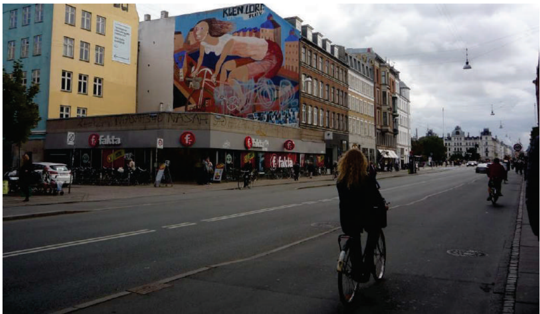
Abb. 17 Strassenbegleitender Richtungsradweg (2.80 m breit) auf der „Farumruten“ in der Kernstadt in Kopenhagen (DK)
