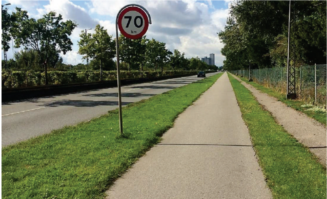
Abb. 16 Strassenbegleitender Richtungsradweg (ca. 2 m breit) auf der „Farumruten“ im Agglomerationsgürtel bei Kopenhagen (DK)
