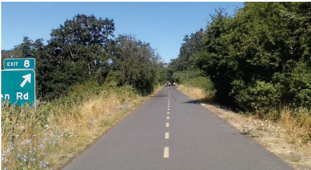
Abb. 15 Strassenbegleitender Zweirichtungsradweg (ca. 3.90 m breit) auf der „Galloping Goose Trail“ im Agglomerationsgürtel bei Victoria, British Columbia (CAN)
